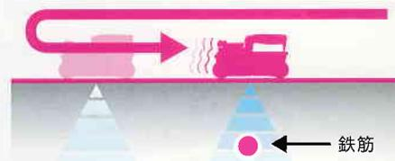
探査途中に気になった箇所に戻り、内部の様子を再確認できるため、精度の高い探査が可能になります。
