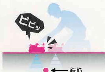
鉄筋位置をブザーとLEDでお知らせ。初めての方でも鉄筋探査が容易になります。
