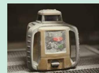
防塵テスト：JIS 保護等級 6 級 75μm(0.075mm)のパウダー粉が内部に侵入しない
