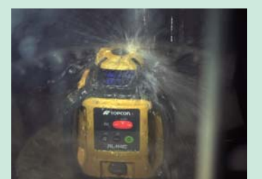
防水テスト：JIS 保護等級 6 級 全方向からの強力なジェット噴流水に耐える
